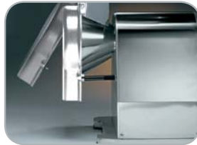
Protezione su bocca campana in ABS con micromagnete. Guard on disc holder opening.
